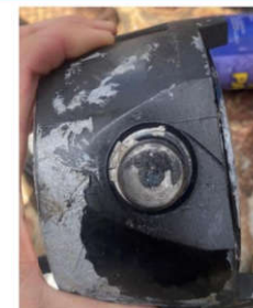
รูปที่ 2. เกจวัดความดันที่อุดตัน
